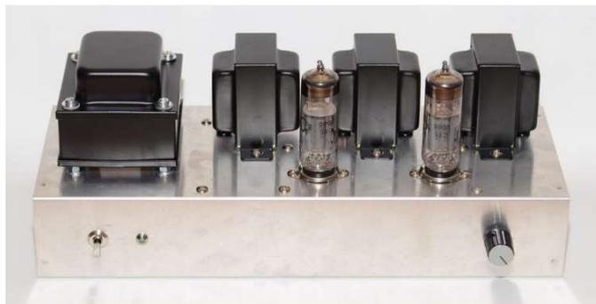
初心者でも組み立てられる真空管アンプとして、真空管2本で構成する本格的な6BM8シングルアンプキットです。最大出力と低歪率を同時に満たすUL接続を採用、最大出力2.7W（歪率5%）が得られています。同時に低雑音で、残留ノイズは $35\mu\text{V}$ （JIS-A補正）に止まります。これまでも6BM8シングルアンプのキットが市販されてきましたが、歪率10%という緩く規定した最大出力でさえも五極管接続のもので2W、三極管接続のもので1.5Wに止まっています。これらキットでは製作の容易さからプリント基板を使っていますが、本機ではプリント基板を廃した本格的な配線方法を採用しています。
