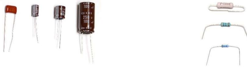
左から ① フィルムコンデンサー $0.047\mu\text{F}$ 、② 電解コンデンサー $100\mu\text{F}16\text{V}$ 、③ 同 $330\mu\text{F}35\text{V}$ 、
