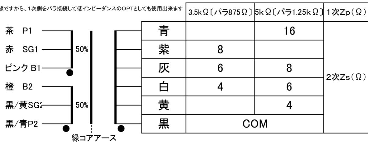
出力 50W(40Hz 5k-4Ω) [(64W Max (40Hz 3.5k-4Ω))]
