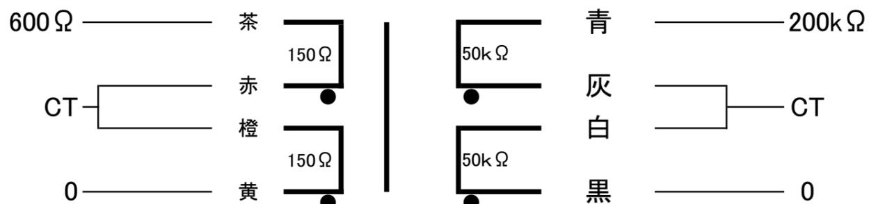
変圧比 1:18.3 最大入力電圧 10V(50Hz)
